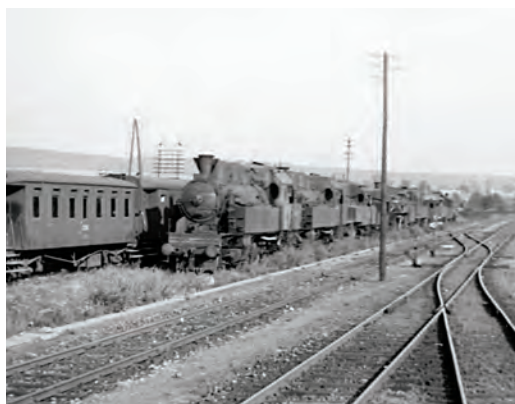
Lokomotivy odstavené po válce ve Svitavách, event. na jiném (neznámém) místě. Vlevo: lokomotivy řady 354.1, 324.218 (či 208) a 423.0. Vpravo: dvě lokomotivy z řady 354.1, za ní pak 423.0 a asi 365.0 nebo 534.0. (Karel Trojánek)
